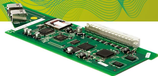
Système centralisé de messagerie vocale et fax à 8 canaux permettant de gérer jusqu'à 120 boîtes de messagerie vocale et 120 boîtes de fax pour le COMmander 6000
